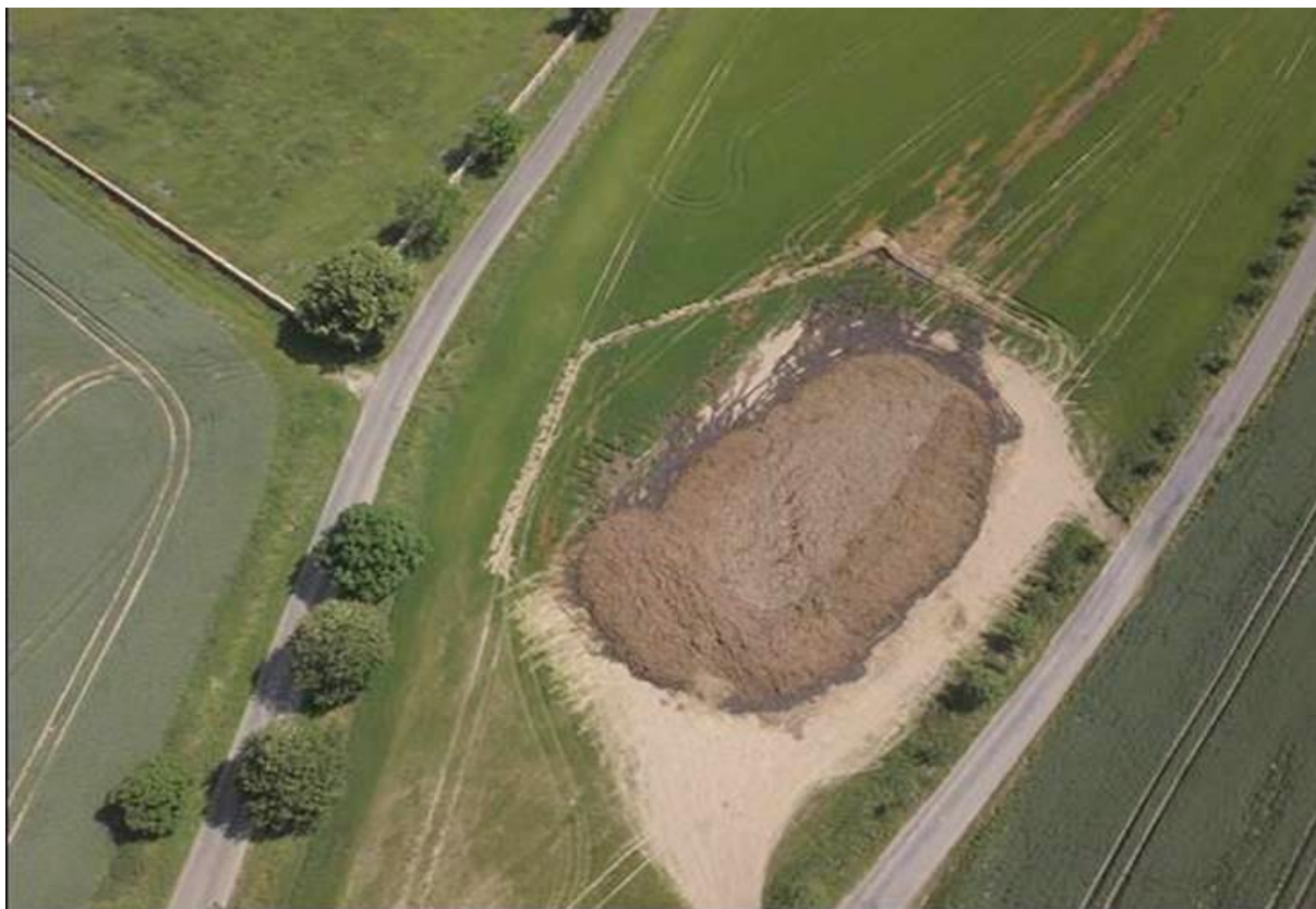
Snímek 4: Celkový pohled na složiště hnoje se zábranami a únik hnojůvky viditelný v porostu ječmene
