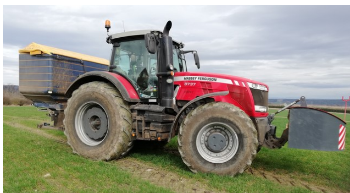
Obrázek 14 Pracovní souprava neseného rozmetadla průmyslových hnojiv Bogballe M6W (Naložený zásobník 5,8 t, aplikace - LAD 27 (ledek dolomitický), nastavený záběr rozmetání 30 m) v agregaci s kolovým traktorem Massey Ferguson 8737 DYNATractor (dotížení přední nápravy – 1800 kg)
