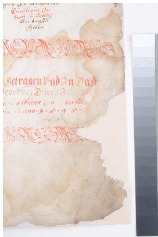
Broumovský herbář – ztráty papírové podložky doplňovány v bloku pomocí lokálních záplat z předem ručně odlitých papírů. K jejich výrobě byla použita papírovina (60 % bavlna, 40 % len) tónovaná pomocí stálobarevných azobarviv. Detail titulního listu před zásahem a po doplnění ztráty papírové podložky.
