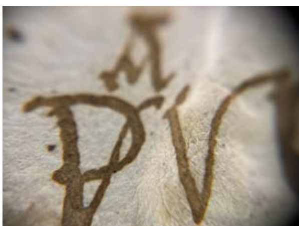
Broumovský herbář – fotografie dokumentující míru povrchového znečištění papírové podložky a účinnost provedeného čištění za použití měkkých latexových gum.
