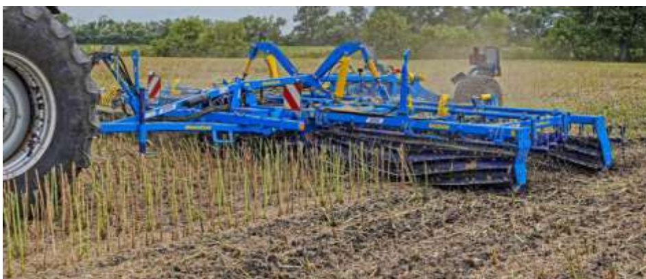
Obr. 2: Velmi mělká podmítka po ozimé řepce s použitím nožových válců
