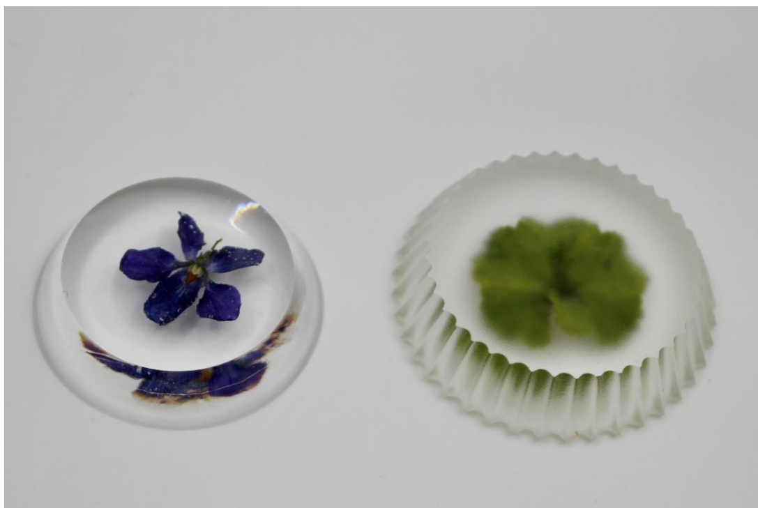
Obr. 15: Výsledek vhodně (vlevo) a nevhodně (vpravo) zvolené formy pro odlití vzorku
