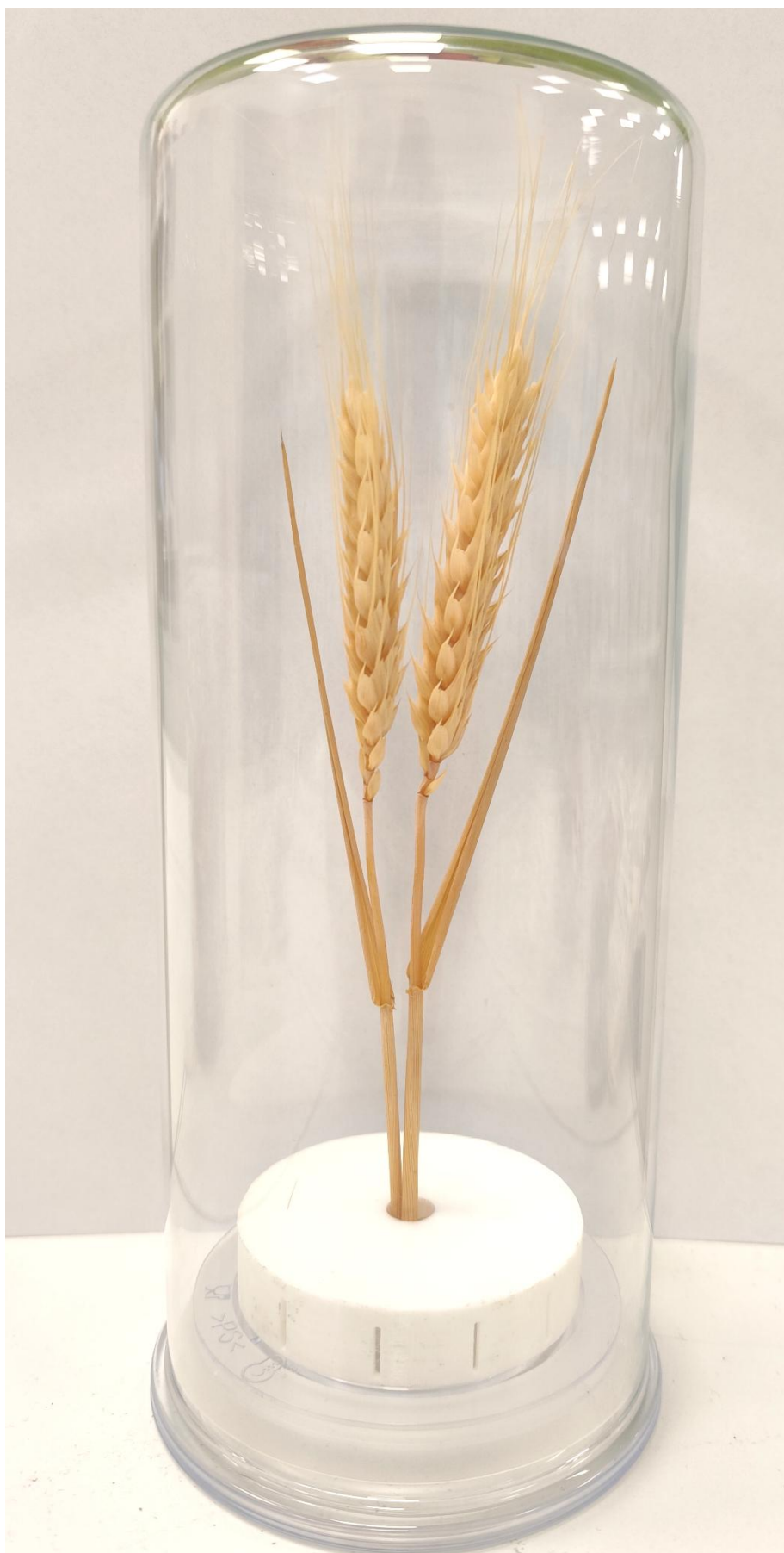
2: Ukázka uchycení rostliny do 3D podstavce se zásobníkem pro silikagel
