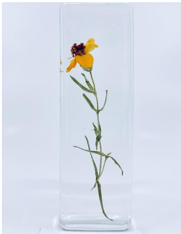
Obr. 18: Žloutnutí pryskyřice při dlouhodobém skladování po 2,5 letech
