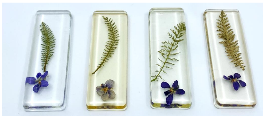
Obr. 18: Žloutnutí pryskyřice při dlouhodobém skladování po 2,5 letech
