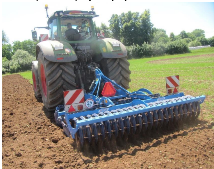
Obr. 2: Zpracování půdy disky s pěchovacími a drobicími V válci
